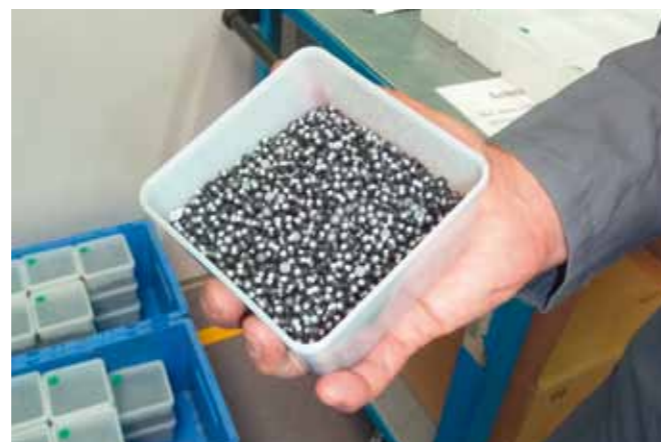
K neuvěření: na první pohled vypadají jako syrové jedlé bobule, ale přitom jsou to ve skutečnosti malé elektrické motorky pro řízení tachometrů a ostatních signalizačních zařízení
